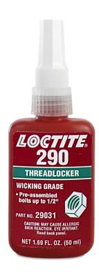
DESCRIZIONE: LOCTITE® 290™ è formulata per bloccare e sigillare i giunti filettati. Per la sua bassa viscosità, il prodotto penetra mediante capillarità tra i filetti già serrati evitando il disassemblaggio delle parti per la sua applicazione. Il prodotto polimerizza in assenza di aria e a contatto con metallo prevenendo l'allentamento dovuto ad urti e vibrazioni. Il prodotto può anche sigillare la porosità nelle saldature, fusioni e parti in metallo sinterizzato.
